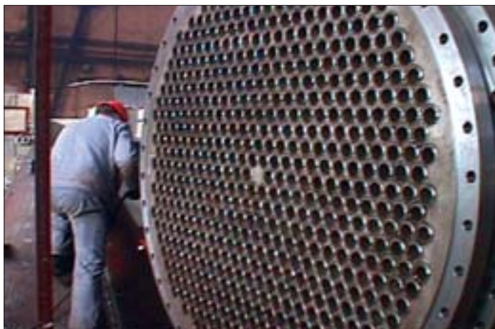
Platerowana niklem ściana sitowa wymiennika ciepła. Wytwórca materiału i wytwórca wymienników ciepła – firmy z Opola
