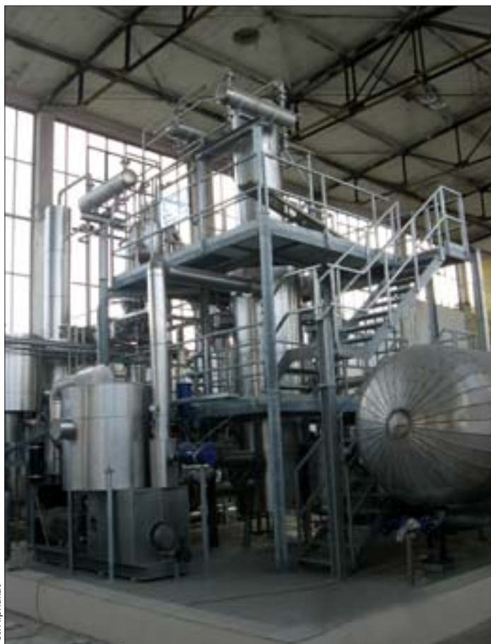
Pierwsza, działająca w skali przemysłowej instalacja KDV-500 wykorzystująca odpady komunalne (Niemcy)
