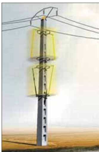
Rys. 2 Wizualizacja możliwości wykorzystania istniejących słupów linii napowietrznych niskich i średnich napięć do zainstalowania turbin wiatrowych [1]
