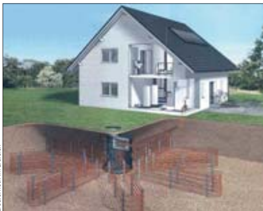
Rys. 3. Dom pasywny z bateriami słonecznymi wspieranymi przez pompę ciepła, wg projektu firmy Roth Werke GmbH w Dautphetal, RFN
